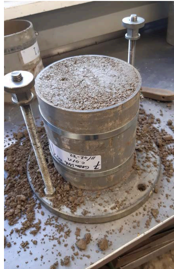
Geprepareerd proefstuk met halfverharding van Graustabiel. (Foto: Fugro)
